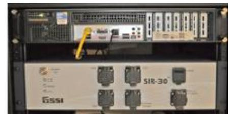
SIR-30<sup>TM</sup> multi canal montado en rack.
