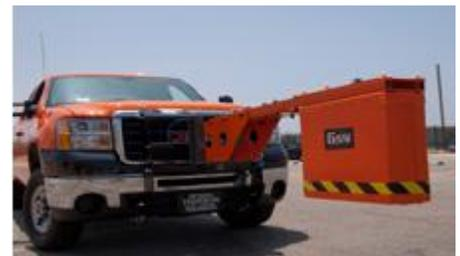
Sistema RoadScan montado en un vehículo integrado con FWD.
